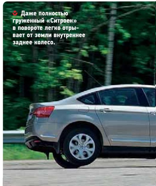
✔ Даже полностью нагруженный «Ситроен» в повороте легко оторывает от земли внутреннее заднее колесо.
