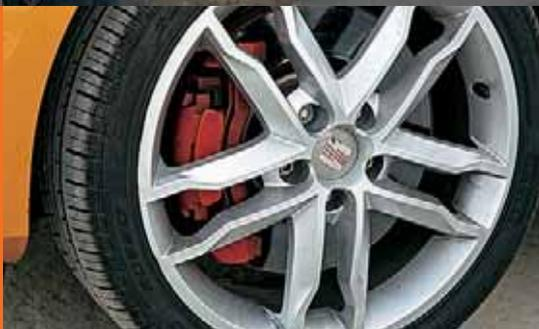
⚡ Штатные «Пирелли» 225/40R18 лучше шин той же модели, но на дюйм меньше. Большого размера тормозные механизмы с колодками «Феродо» не такие аморфные.
