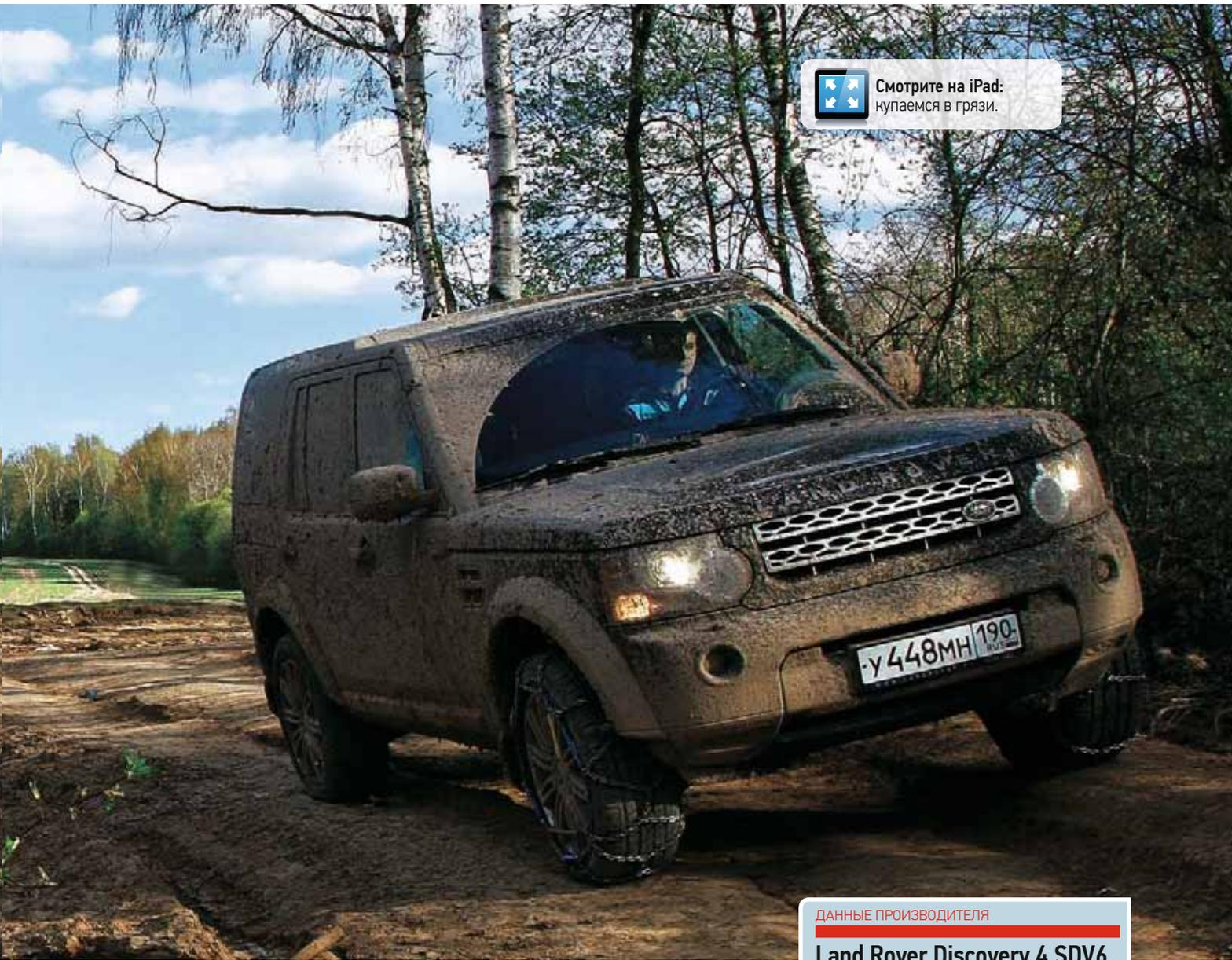
попытка с седьмой-восьмой вытащил нас обратно на сушу. Решили больше судьбу не искушать и достали цепи. С ними «диско» попер, как трактор. Ту же лужу взяли без особого напряжения. Главное – помнить, что двигаться «окольцованными» желательнее без пробуксовки, иначе машина моментально зарывается, причем глубоко. Поэтому, когда чувствую, что начинаю закапываться, сразу коробку в «нейтраль». Тормозить даже в пол бесполезно: антиблокировочная система не дает колесам сразу заблокироваться.
