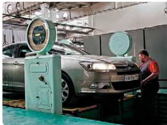
▲ «Ситроен» взвешивают с работающим двигателем. Иначе гидропневматические подвески уйдут в парковочный режим.
