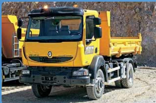
❖ Несмотря на безбидный вид, «Мидлум» снабжен постоянным полным приводом, блокировками межосевого и межколесных дифференциалов и способен взбираться на 50-процентные склоны.
