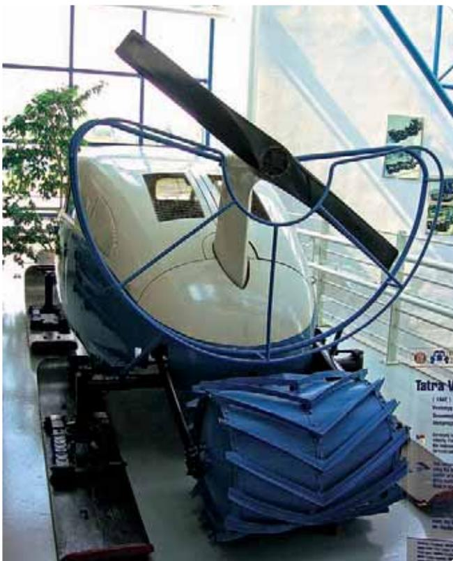
⚡ «Татру-V855» чехи изготовили по заказу вермахта в 1942 году. Машина получилась оригинальная: сзади помимо пропеллера у нее был опускающийся колесный привод с грунтозацепами – для скрытного бесшумного передвижения. Война как-никак.
