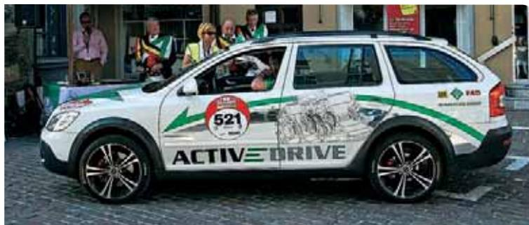
электродифференциалом (eDifferenzial), и именно в нем изюминка проекта. Обычно система динамической стабилизации ESP заставляет автомобиль вернуться на заданную траекторию с помощью точно рассчитанных тормозных импульсов. Электронный дифференциал выполняет ту же задачу не тормозя, а, напротив, подкручивая нужное колесо дополнительно. Оценить работу новинки можно было в ходе ралли электро-автомобилей в Бодензее. Динамика концепта – разгон до сотни за 8,5 с – весьма впечатлила соперников.
