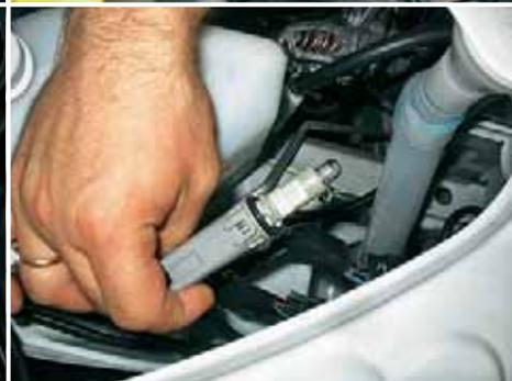
❖ Длинный патрон габаритки позволяет цепко ухватиться за него в тесноте подкапотного пространства. Такое достоинство трудно переоценить.
