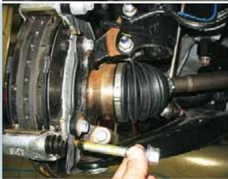
➤ В заднем тормозе палец с резинкой на конце – верхний, а скоба-пищалка тоже на внутренней колодке, но снизу. Наружную колодку вставляем двупалой пластиной в скобу.
