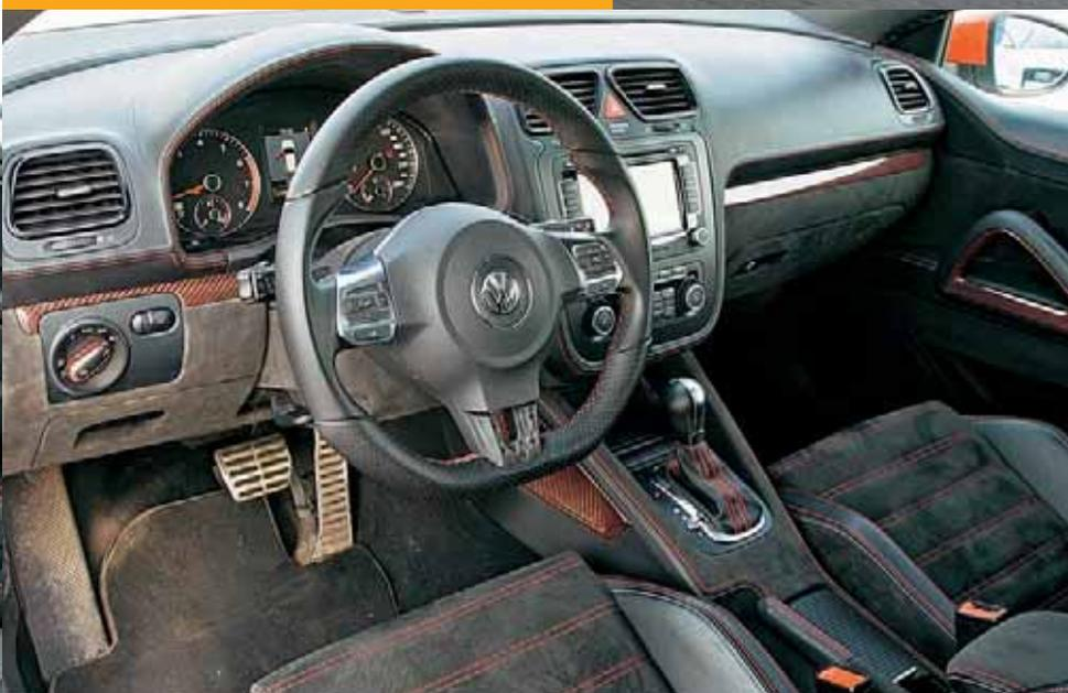
❖ Расположение фиксатора на лобной части селектора – не самое удачное решение. Сам 6-ступенчатый агрегат работает так же, как на остальных машинах: быстро скачет вверх, осторожноничает в ручном режиме.
