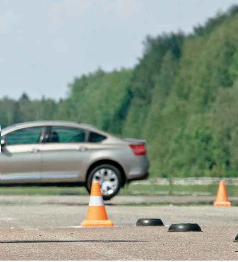
✔ Это не дрег-рейсинг. Перегруженный багажник разгрузил ведущие колеса, поэтому на педаль газа машина реагирует так.
