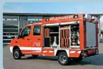
**Н**а выставке спасательных автомобилей «Реттмобиль» в Фульде впервые увидела свет пожарная машина на базе полноприводной версии «Фольксвагена-Крафтер» с двойной кабиной и увеличенным на 100 мм клиренсом. Снаряженная масса такого автомобиля с алюминиевой надстройкой фирмы Furtner & Ammer всего 3,44 т.
