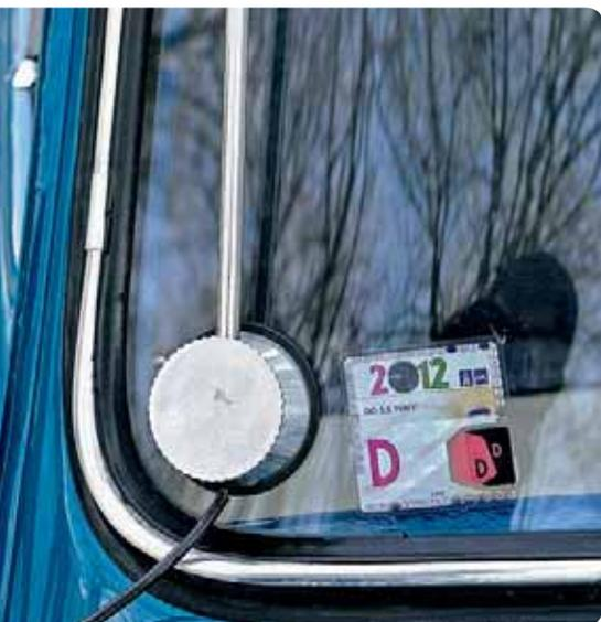
Именно так крепили антенну на машинах с заказными радиоприемниками.
