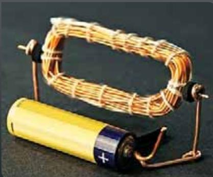
есть все узлы электромоторов постоянного тока: статор (постоянный магнит), ротор (вращающаяся деталь с катушками), коллектор (пластинки, к которым припаяны концы обмоток ротора, – мы обошлись простой зачисткой концов катушки с одной стороны), щетки (их роль у нас выполняют стойки, они же – подшипники). Можно было даже надеть на конец «оси» крыльчатку, тогда бы наш моторчик даже куда-нибудь подул!
