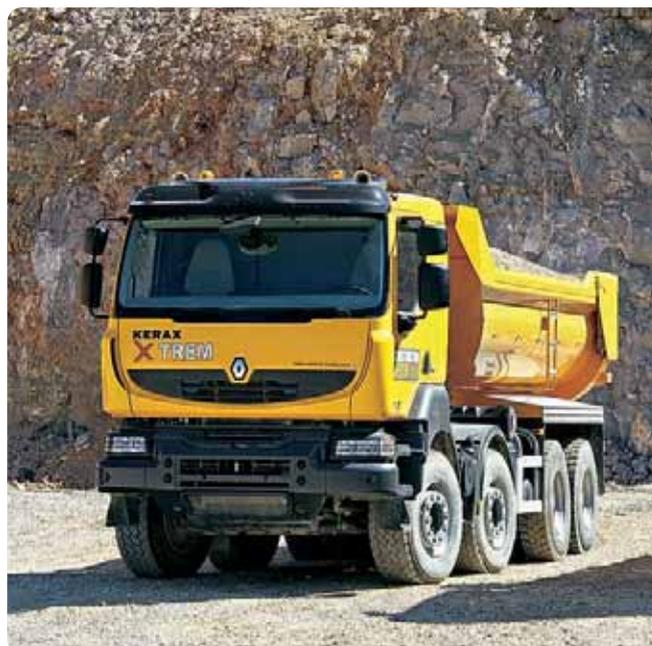
▲ Помимо самосвального кузова на «Керакс 8×4 Экстрим» можно монтировать самые разнообразные надстройки – краны, бетономешалки, насосы.
