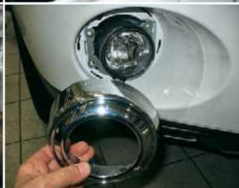
❖ Для замены противотуманки поверните декоративное обрамление против часовой стрелки и выверните три самореза крепления фары. Все просто, но этим, увы, зачастую пользуются воры.
