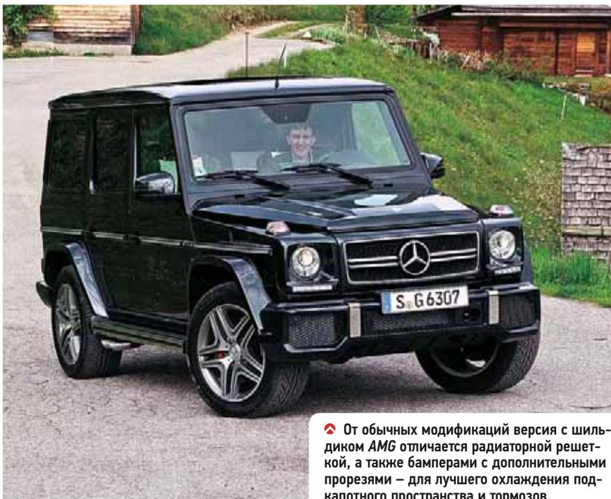
От обычных модификаций версия с шильдиком AMG отличается радиаторной решеткой, а также бамперами с дополнительными прорезями – для лучшего охлаждения подкапотного пространства и тормозов.
