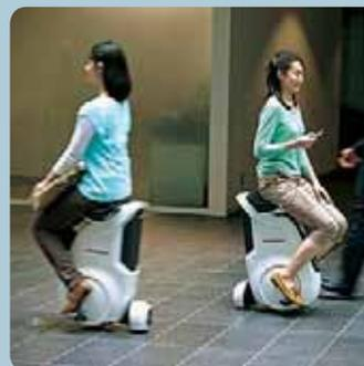
**В**Токио показали новое транспортное средство «Хонда Юни-Куб», по принципу работы близкое к американскому сигвею. Главных отличий два: ехать на нем нужно сидя, а запатентованная система Omni Traction Drive System позволяет менять направление движения, не поворачивая. Максимальная новинки скромная – всего 6 км/ч, но ведь предназначена она в первую очередь для использования в помещениях.
