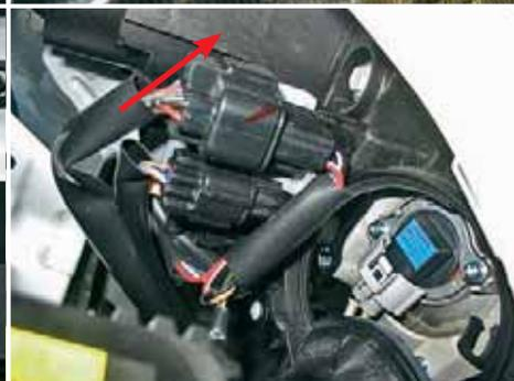
❖ Для доступа к лампам дальнего света снимаем колпак, повернув его против часовой стрелки. Фиксация лампы H11 надежна и удобна при замене. Секция ближнего света показана стрелкой.
