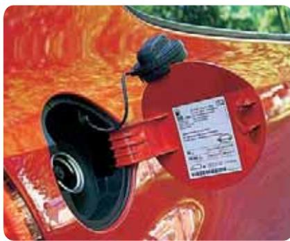
▲ Шнурок, которым «привязана» пробка бензобака, на морозе теряет эластичность и не дает повесить пробку на лючок.
