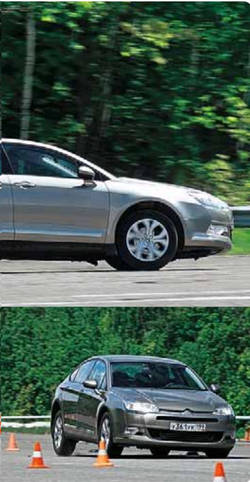
↻ Заметный крен на переставке вызван, скорее всего, сработавшей системой стабилизации, которая притормозила одно из колес.
