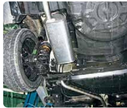
⚡ В задней подвеске с упругой H-образной балкой ломаться нечему. Выпускная система служит более 150 тыс. км. Обратите внимание на добротный слой пластизола на днище: это не только антикор, но и шумоизоляция.
