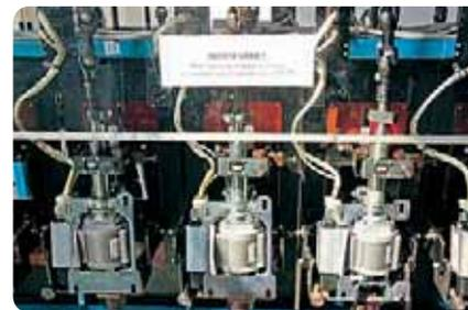
Прежде чем отправить на конвейер, ЭМУРУ обкатывают на стенде в течение 45 минут с 30-процентной нагрузкой.
