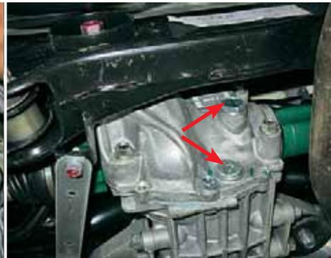
❖ Электромагнитная муфта подключения заднего моста находится в общем картере редуктора и отделена от него сальником. Заливная пробка на картере под ключ «на 24», сливная – под шестигранник «на 10» (стрелки).
