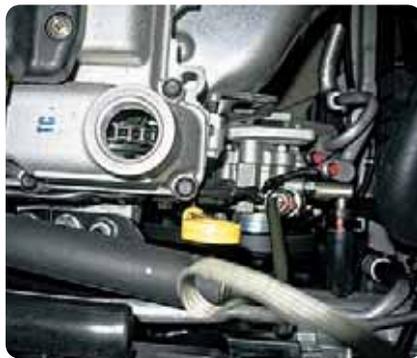
⚡ ГРМ двигателя B12D приводится практически вечной однорядной цепью (видна через отверстие снятой крышки маслозаливной горловины). Остальные моторы имеют ременный привод ГРМ, – не забывайте менять в срок!
