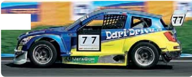
▲ **«Митджет» (MitJet; статус – Кубок РАФ).** Класс идентичных по конструкции прототипов французского производства, оснащенных одинаковыми 1,3-литровыми моторами мощностью до 150 л.с. При этом машина вдвое легче обычной кольцевой легковушки (520 кг против 1000–1100 кг), что обеспечивает отличную динамику разгона. «Фишка» «Митджета» – пластиковая облицовка стилизована под спортивные машины, например «Астон Мартин» или «Порше».
