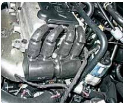
⚡ Токоведущая жила высоковольтных проводов чаще перегорает со стороны свечных наконечников. Меняя провода, вряд ли запутаешься: все они пронумерованы, как и выходы на катушках, в соответствии с порядковым номером цилиндра. Начало отсчета – со стороны приводных ремней.
