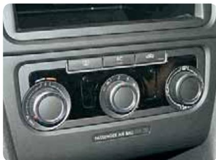
⚡ Не совсем удобна ручка регулировки температуры. При повороте влево до упора автоматически включается кондиционер и рециркуляция. Чтобы найти режим приточной вентиляции, приходится немного возвращать рукоятку назад и ловить нужное положение. Здесь не хватает ощутимого порога срабатывания.
