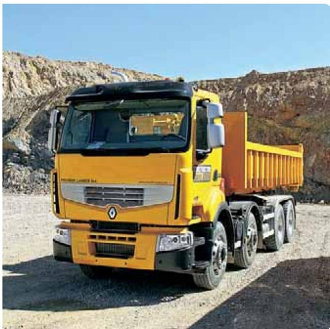
▲ Еще одна новинка из гаммы «Премиум Лендер» – шасси с колесной формулой 8×4. Любопытно, что это семейство предлагается с двумя типами кабин: более низкими по посадке (от развозных машин) и высокими (от магистральных тягачей). Здесь – последний вариант.
