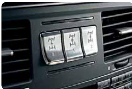
↗ Водитель не запутается, в какой последовательности задействовать блокировки: клавиши пронумерованы.
