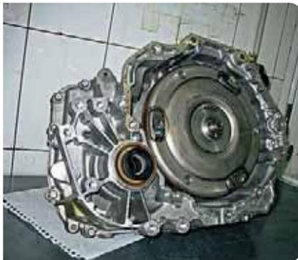
⚡ Этот автомат попал в ремонт по глупости владельца: тот прогревал агрегат на месте при положении селектора в позиции *D* («драйв»), газа и тормоза одновременно. Сальники приводных валов здесь пока абсолютно сухие (пробег 46 тыс. км).
