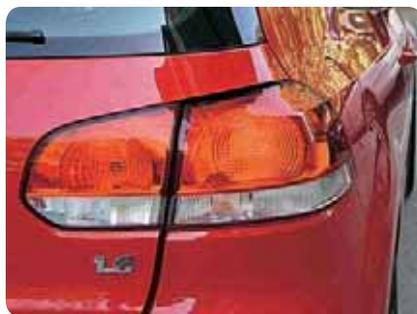
⚡ Задние дублированные габаритки работают необычно. Постоянно горят только внешние элементы, расположенные на самом кузове. Внутренние, что на двери задка, гаснут при открытии двери. Видимо, данное решение призвано беречь лампочки: чтобы не стряхнуть нити при захлопывании двери багажника.
