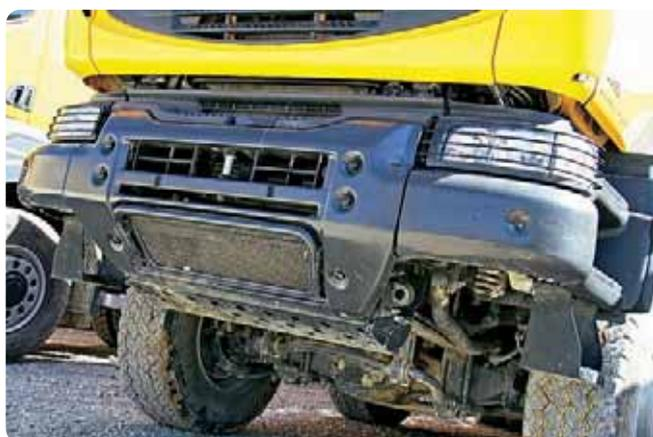
Высокий дорожный просвет, рекордный в классе угол въезда и мощная стальная защита двигателя сразу указывают на экстремальные условия работы этого «Керакса».
